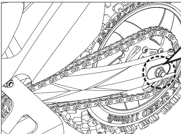
如果链条太紧，请用RB-C006替换RB-C002，且将偏心孔位朝向前轮，如下图所示。
